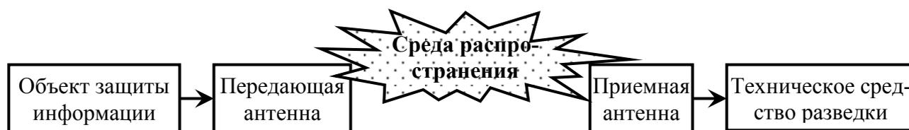
Рис. 1.4. Технический канал утечки информации
