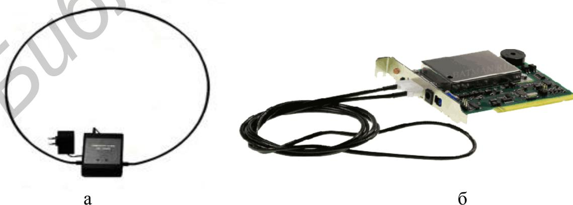
Рис. 2.4. Внешний вид генераторов шума:
