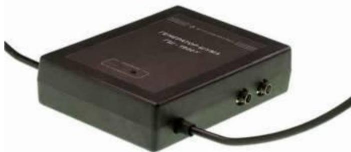
Рис. 2.7. Внешний вид генератора шума ГШ -1000У
