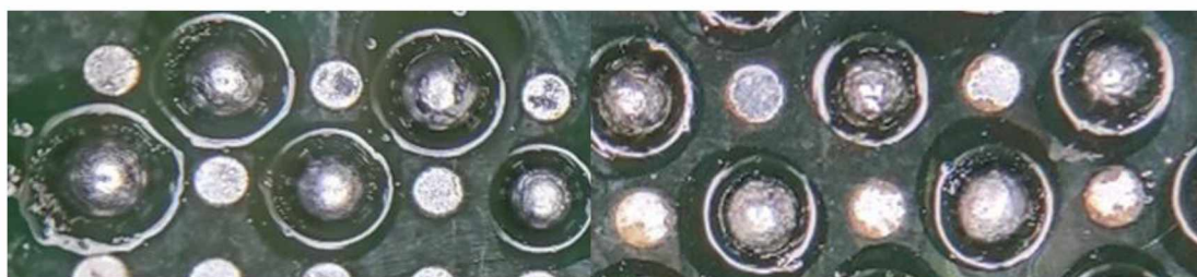
Рисунок 2 – Внешний вид шариков, образованных из паяльной пасты
