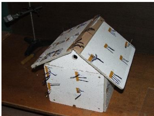
Рисунок 13 – Модель домика, обклеенная полосками фольги (вид спереди)
