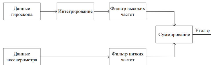
Рисунок 1 – Структурная схема комплементарного фильтра для МЭМС гироскопа и акселерометра
