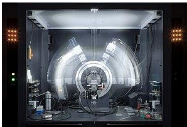
Рисунок 2 – Порошковый рентгеновский дифрактометр во время работы
