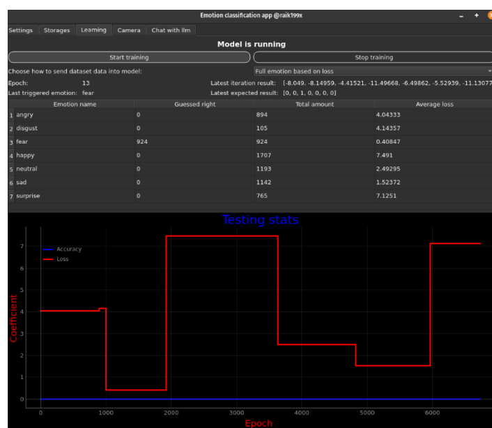
Рисунок 3 — Результат обучения модели при учете наибольшей ошибки и обработки одной конкретной эмоции целиком.
