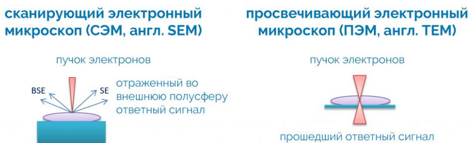
Рисунок 6 – Сканирующий электронный микроскоп (СЭМ) и трансмиссионный электронный микроскоп (ТЭМ)
