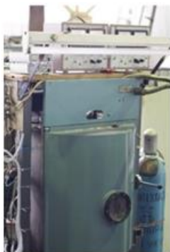
Рисунок 1 – Вакуумная установка криохимического синтеза металлополимерных тонкопленочных покрытий
