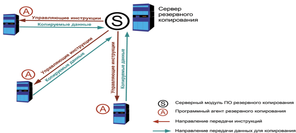
Рисунок 2 – Централизованная схема резервного копирования
