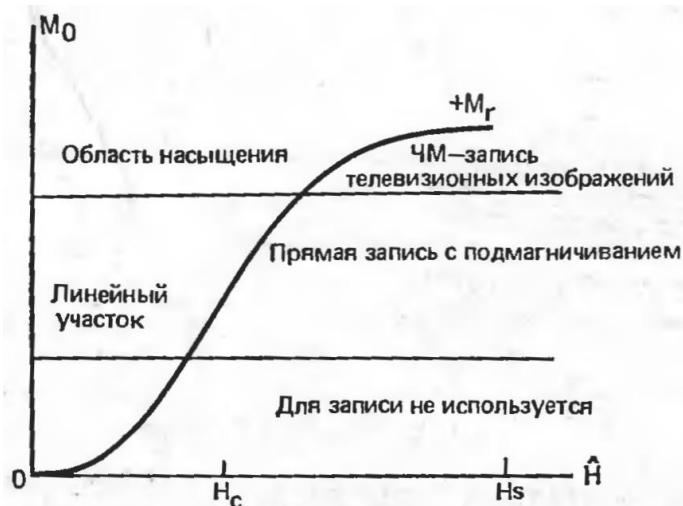
Рисунок 4 - График кривой остаточной намагниченности материала
