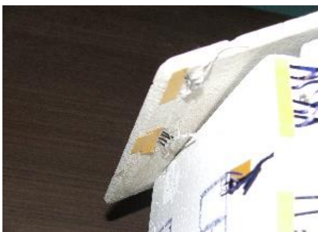
Рисунок 15 – Модель домика, обклеенная полосками фольги (вид под напуском крыши)
