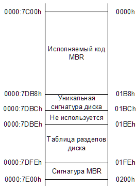
Рисунок 1 – Схематическое изображение структуры MBR
