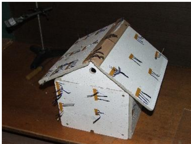
Рисунок 13 – Модель домика, обклеенная полосками фольги (вид спереди)
