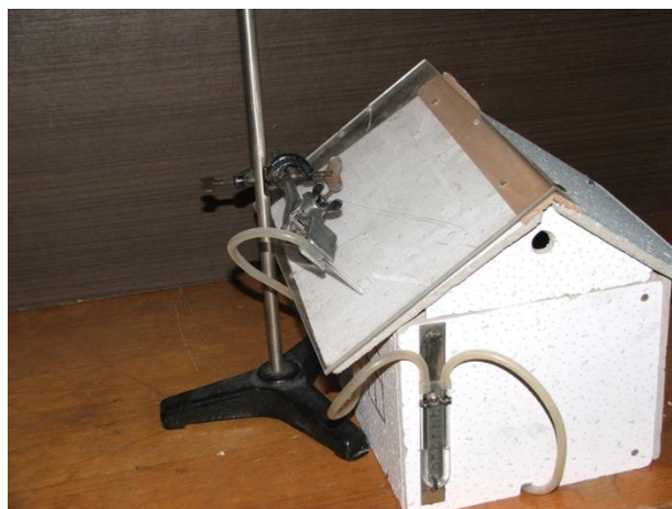
Рисунок 9 – Модель домика с тонким листом оргстекла на крыше
