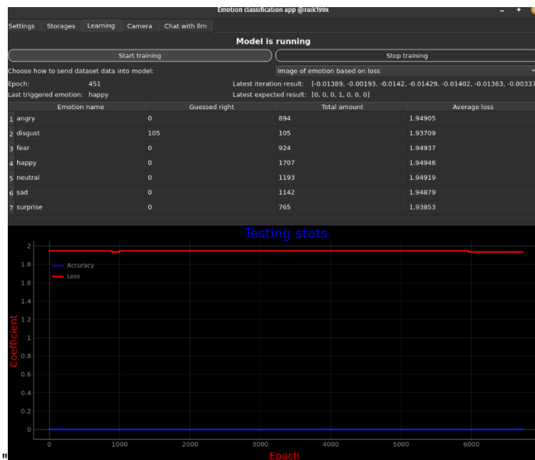
Рисунок 4 — Результат обучения модели при использовании одной фотографии с учётом коэффициента ошибки.
