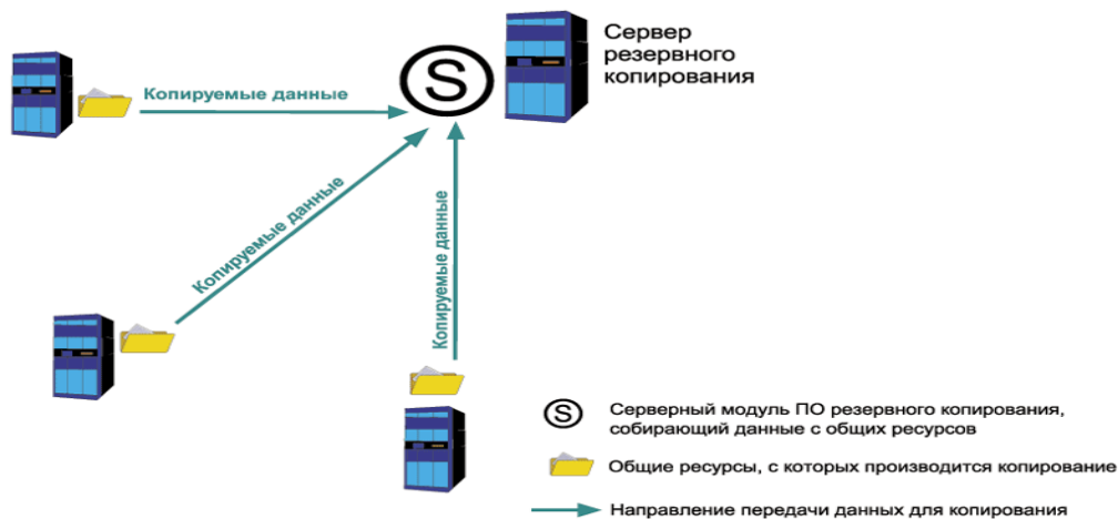
Рисунок 3 – Упрощенная централизованная схема резервного копирования
