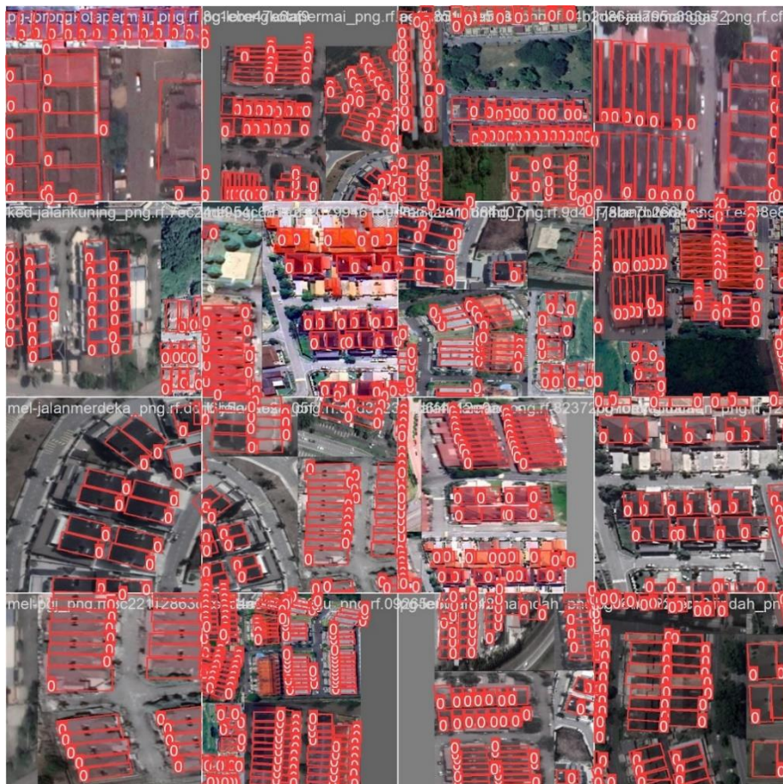
Рисунок 1 – Пример обработки изображений нейронной сетью
