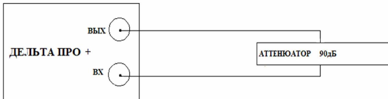
Рисунок 3 – Схема соединения приборов при проверке перекрываемого затухания
