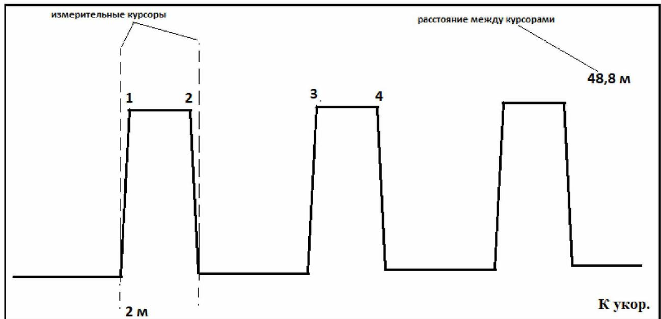
Рисунок 2 – Изображение на экране прибора калибровочных меток
