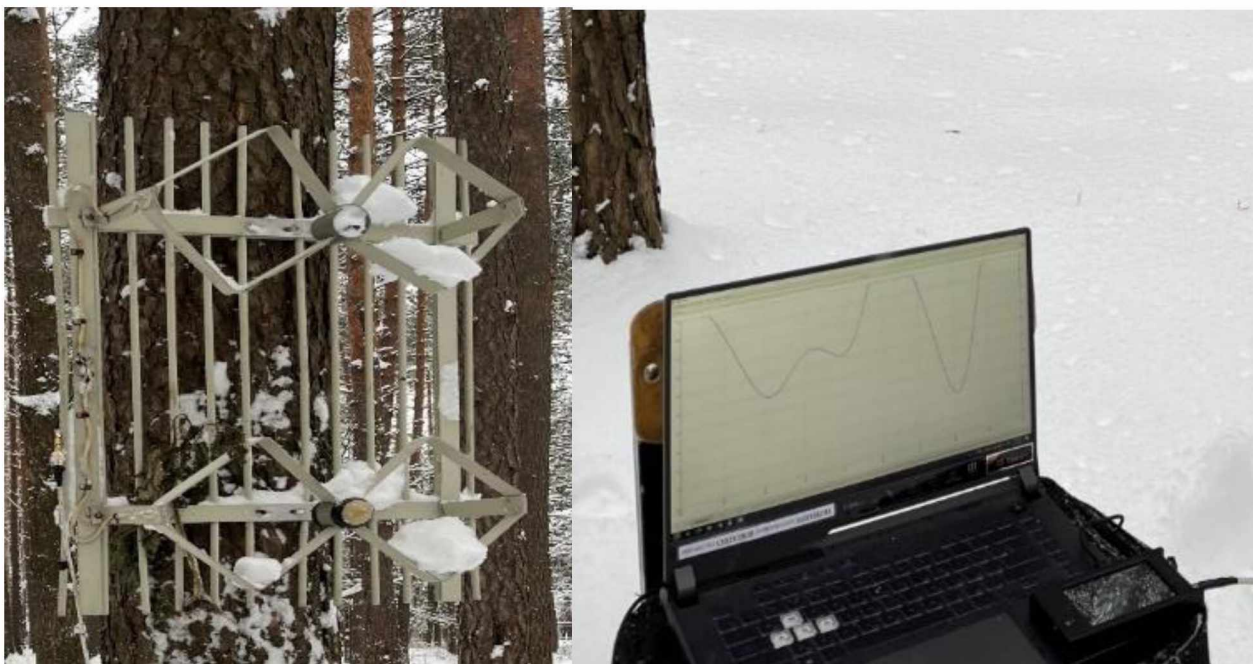
Рисунок 1 – Проведение измерений параметров АУ при наличии на антенне снежного покрова и обледенения
