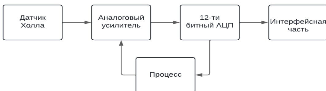
Рисунок 2 – Схема внутреннего устройства AS5600
