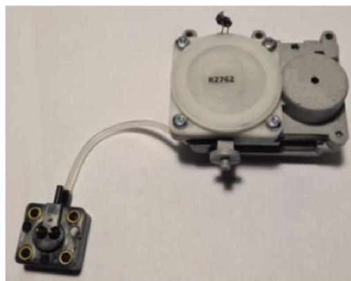
Рис. 1. Внешний вид электрохимического датчика и системы отбора проб дыхания
