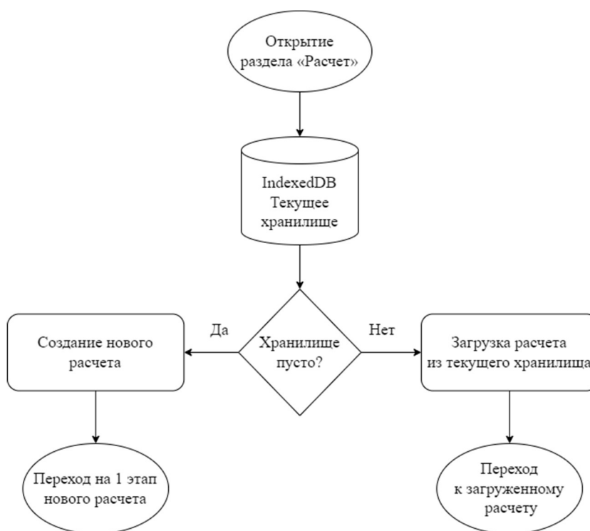
Рисунок 2 – Алгоритм взаимодействия приложения с БД при открытии раздела «Расчет»
