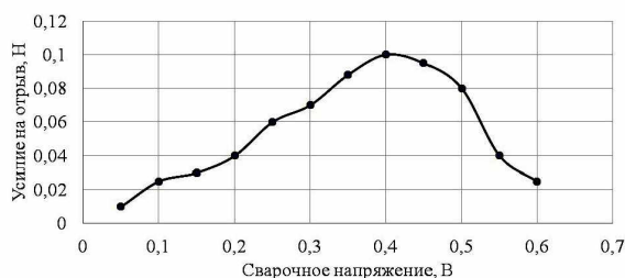
Рисунок 2.2 – Зависимость усилия на отрыв от величины сварочного напряжения
