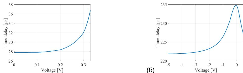
Рисунок 3. Зависимости вносимых временных задержек от приложенного к управляемому контакту напряжения для термооптического (а) и электрооптического ИМЦ (б)
