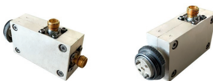
Рис. 13. Внешний вид смесителя со встроенным дуплексером Fig. 13. External view of a mixer with a built-in diplexer
