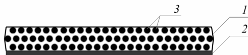
Рис. 1. Схематическое изображение изготовленных образцов: 1 — емкость, сформированная из полимерной самоклеящейся пленки; 2 — фольгированная полимерная пленка; 3 — частицы угля или никельсодержащего угля.
