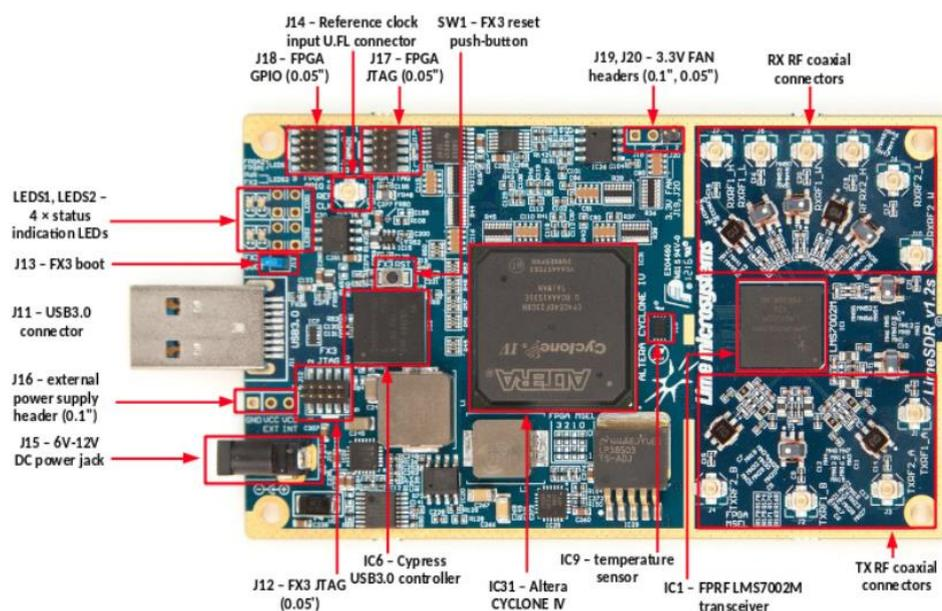
Рис. 3. Внешний вид платы 2×2 MIMO LimeSDR
