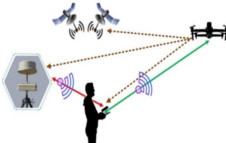
Рис. 1. Схема взаимодействия оператора, БЛА и радиопеленгатора
