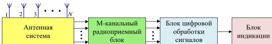
Рис. 2. Типовая структурная схема радиопеленгатора
