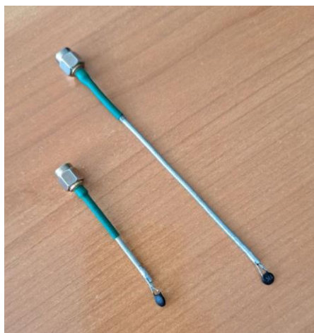
Рис.2. Внешний вид трансформатора импедансов с выносным датчиком регистрируемого параметра среды
