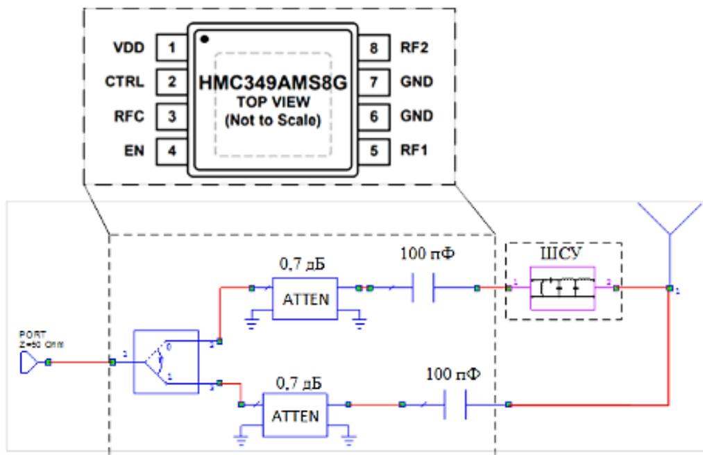
**Рис. 3.** Принципиальная схема высокочастотного коммутатора
