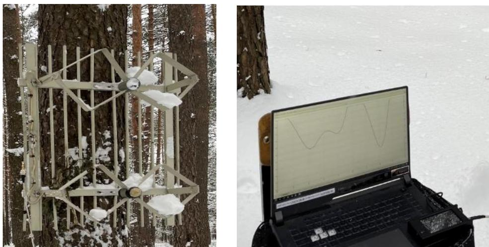
**Рис. 1.** Проведение измерений параметров АУ при наличии на антенне снежного покрова и обледенения
