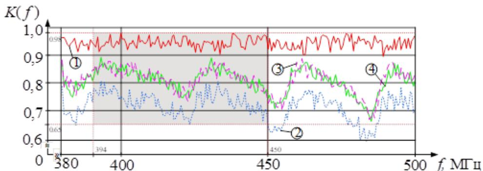
**Рис. 2.** Зависимость КПМ антенной системы от частоты
