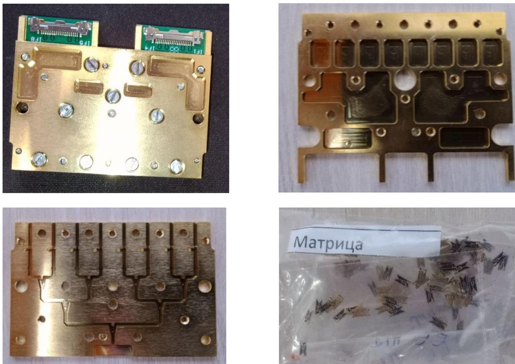
**Рис. 8.** Восьмиканальный супергетеродинный приемник 94 ГГц
