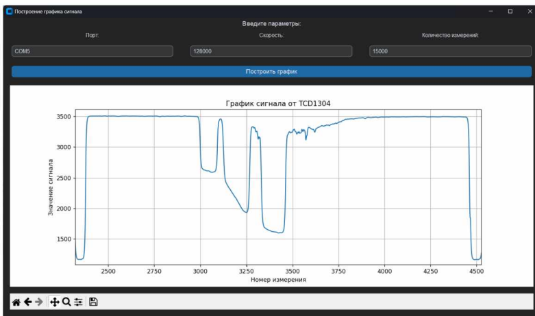
Рис. 3. Отображение сигнала с ПЗС-линейки
