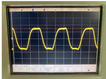
Рис.8. Прямоугольные импульсы с частотой 163 МГц
