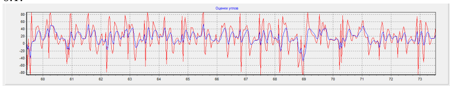
Рис. 7. Оценка углов с помощью комплементарного фильтра
