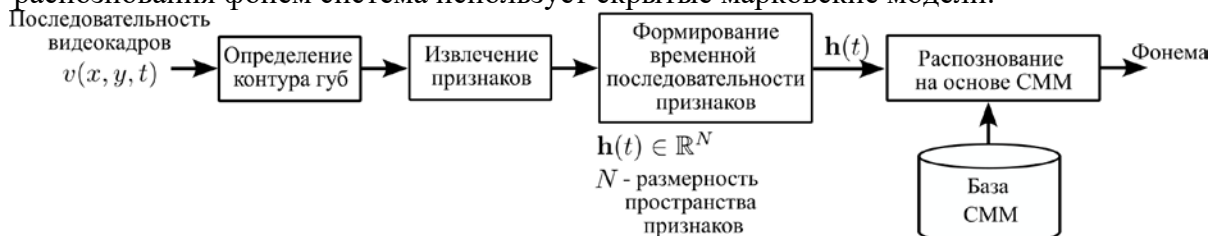
Рисунок 2. Структура автоматической системы чтения по губам на основе СММ
