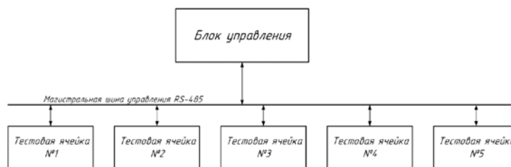
Рисунок 1. Структурная схема автоматизированной система для проведения исследований медицинских имплантируемых приборов
