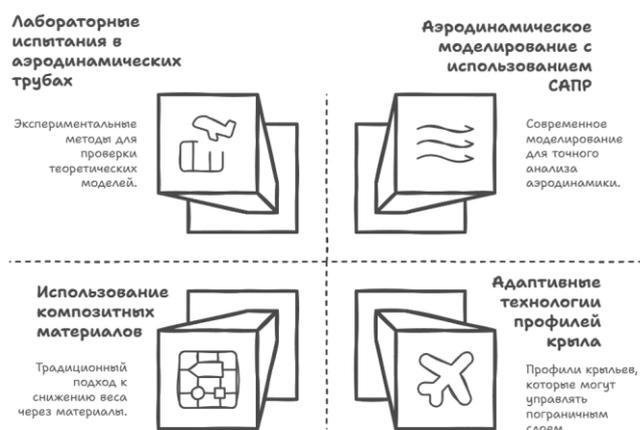
Рисунок 1 – Методы проектирования профилей крыла БПЛА
