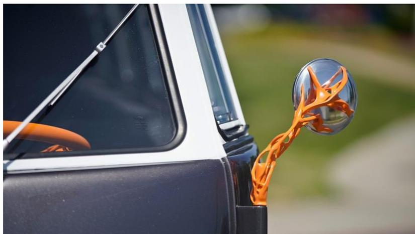
Рисунок 2 – Использование технологии генеративного дизайна для модернизации креплений зеркал заднего вида
