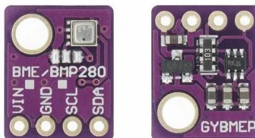
Рисунок 2 – Датчик *BME280*
