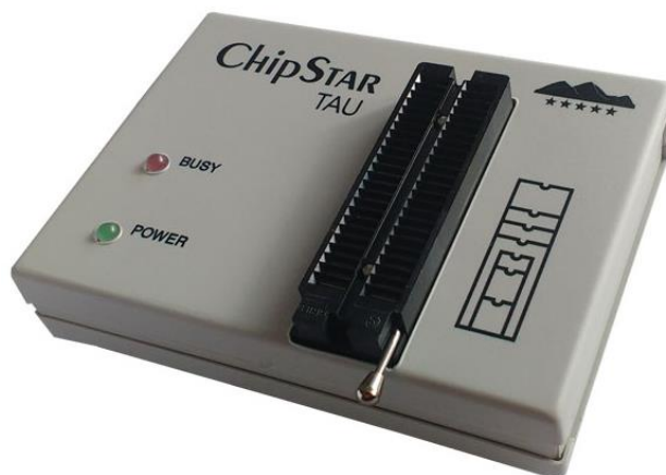
Рисунок 1 – Программатор универсальный ChipStarTAU gold
