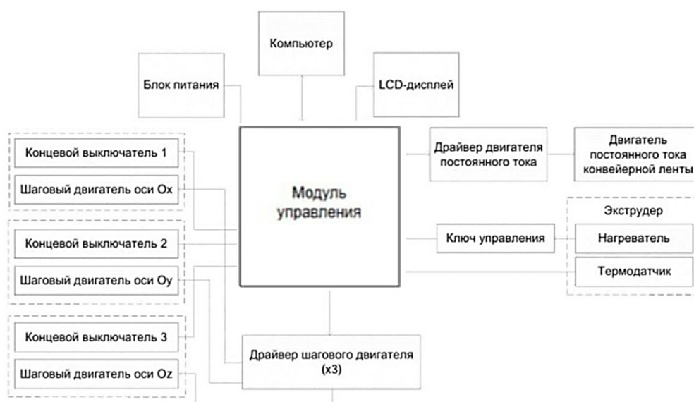
Рисунок 1 – Структурная схема 3D-принтера
