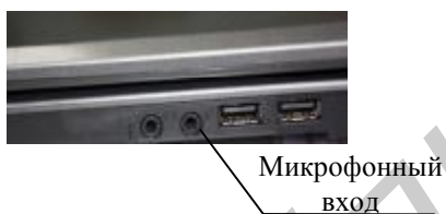
Рис. 7.3. Входы звуковой карты на ноутбуке
