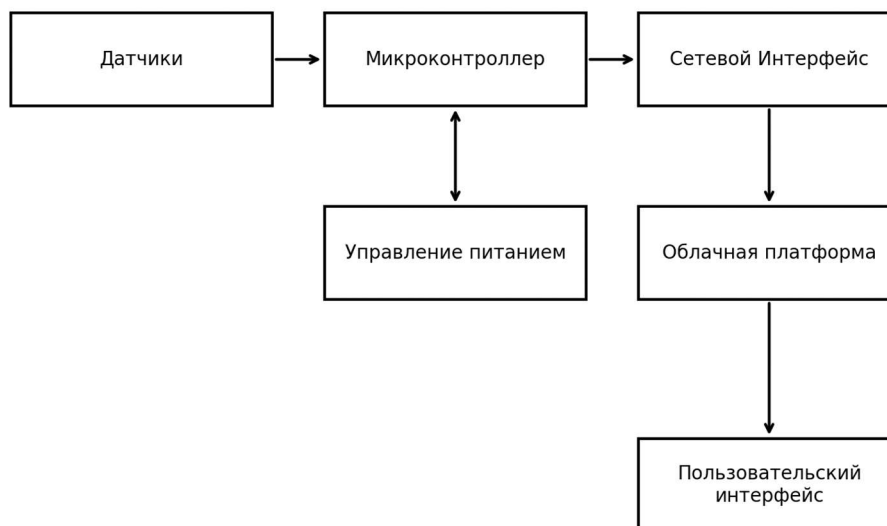
Рисунок 1 – Структура IoT-устройства для мониторинга электромагнитного спектра.
