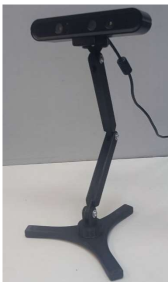
Рисунок 3 – 3D-датчик глубины Orbbec Astra
