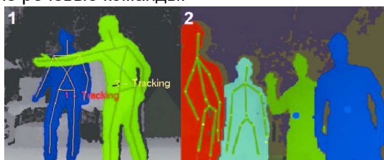
Рисунок 6 – Пример отслеживания скелета с помощью OpenNI [8]
