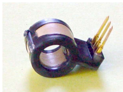
Рисунок 3 – Кольцевой токоизмерительный датчик, работающий на эффекте Холла
