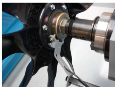
Рисунок 4 – Электрический вентилятор с датчиком Холла
