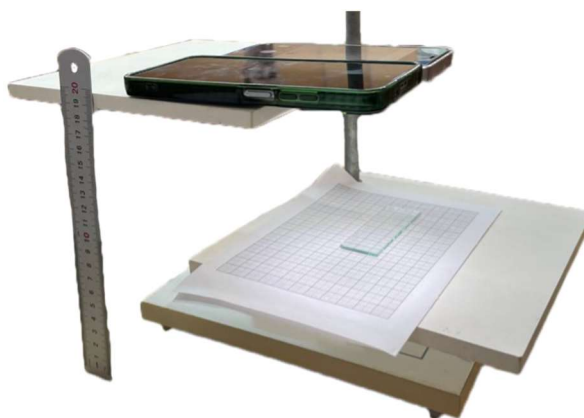
Рис. 1 – Схема экспериментальной установки для измерения увеличения капельной линзы.
