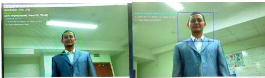
Рисунок 8 – Отслеживание объектов с помощью CSRT и измерение координат в Raspberry Pi
