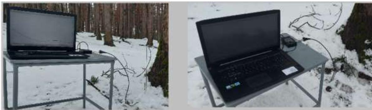
Рисунок 7 – Измерение уровня КСВ J-антенны при попадании снега или ветки между излучателем и обвесом
