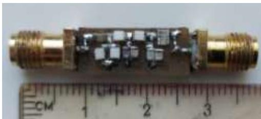
Рисунок 6 – Снимок синтезированного согласующего устройства
