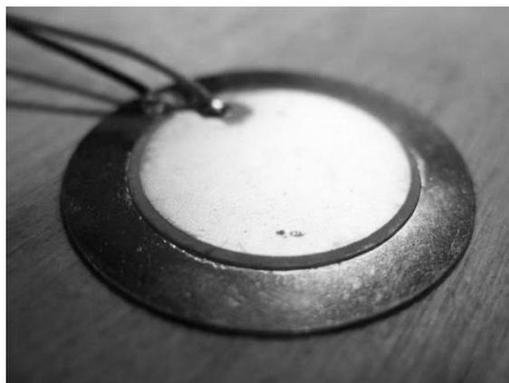
Рисунок 3.6 – Преобразователь со сплошными электродами
