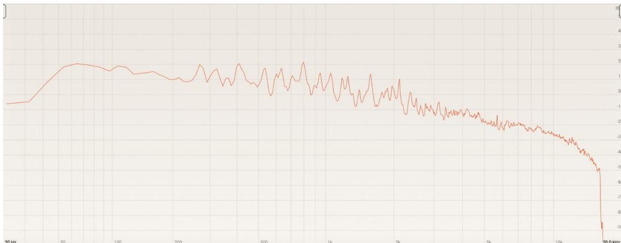
Рис. 2. График АЧХ музыкального трека с использованием кодека аудио с потерями (loosy) MP3 44,1 кГц, 128 kbps
