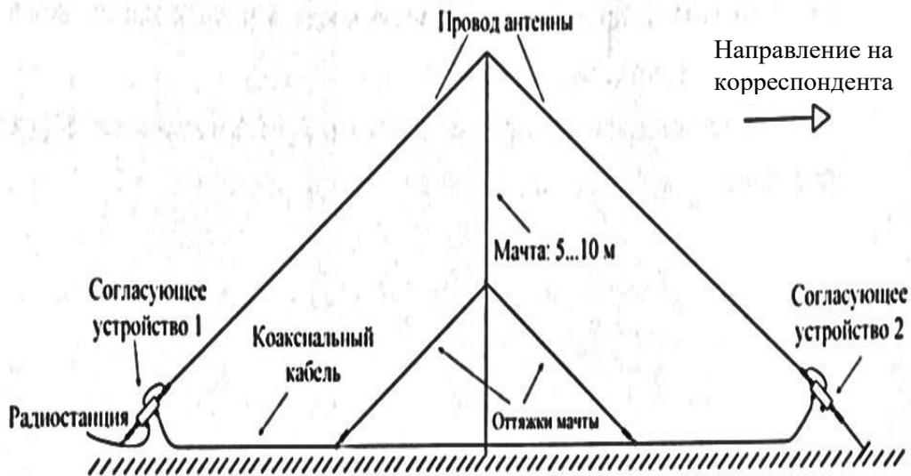
Рисунок 7 – Антенна «ПОЛУРОМБ», вид сбоку
