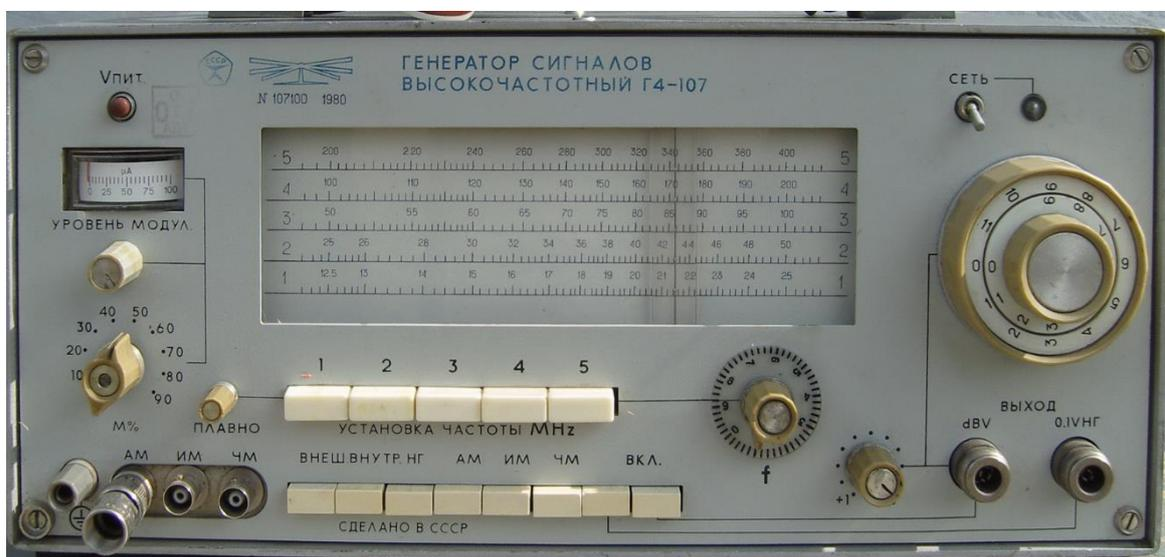
Рисунок Б.2 – Внешний вид генератора сигналов Г4-107
