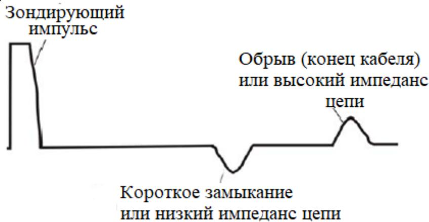
Рисунок Е.1 – Рефлектограмма исследуемой линии передачи
