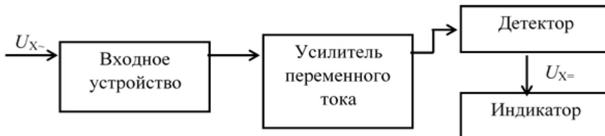
Рисунок Г.1 – Структурная схема микровольтметра ВЗ-40
