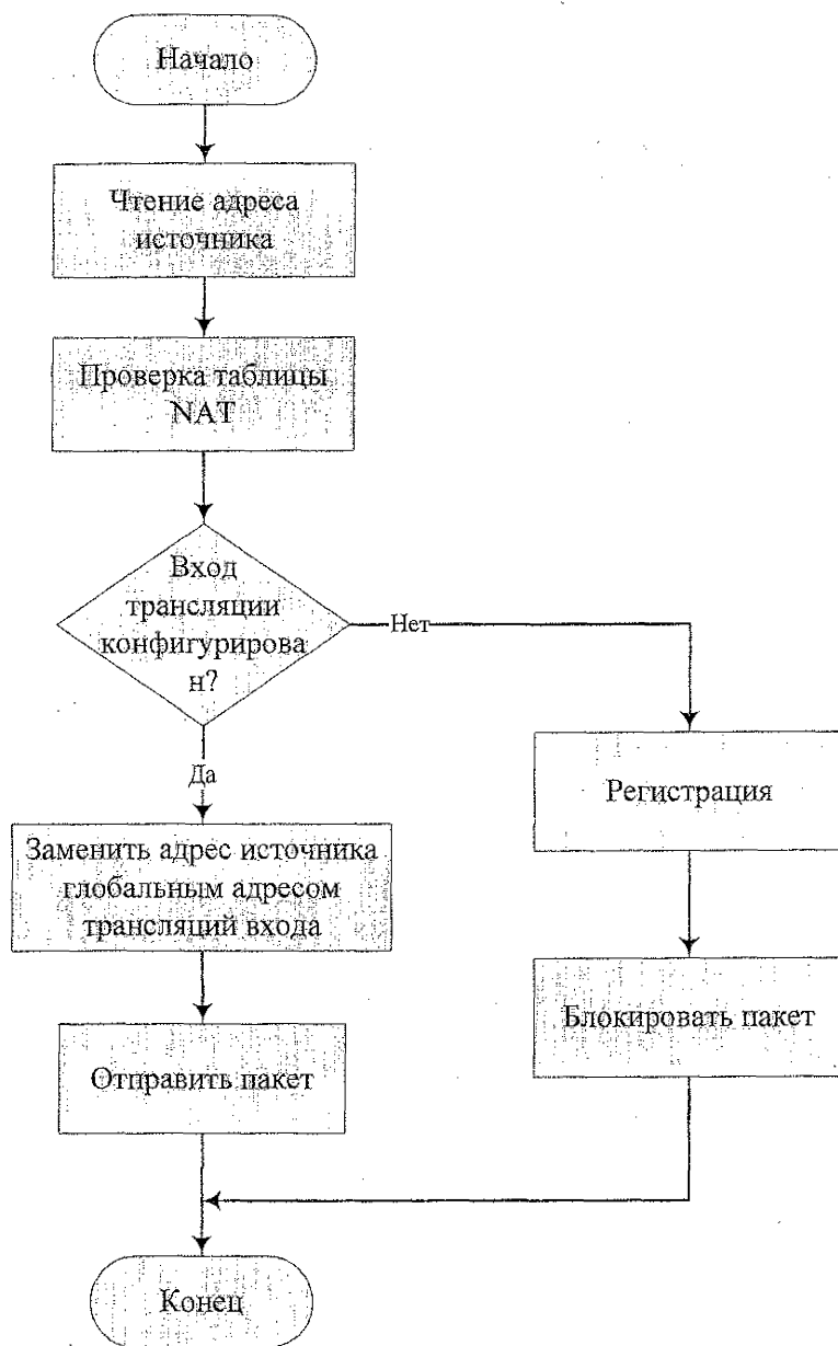
Рис. 2. Алгоритм трансляции внутреннего адреса источника статическим методом
