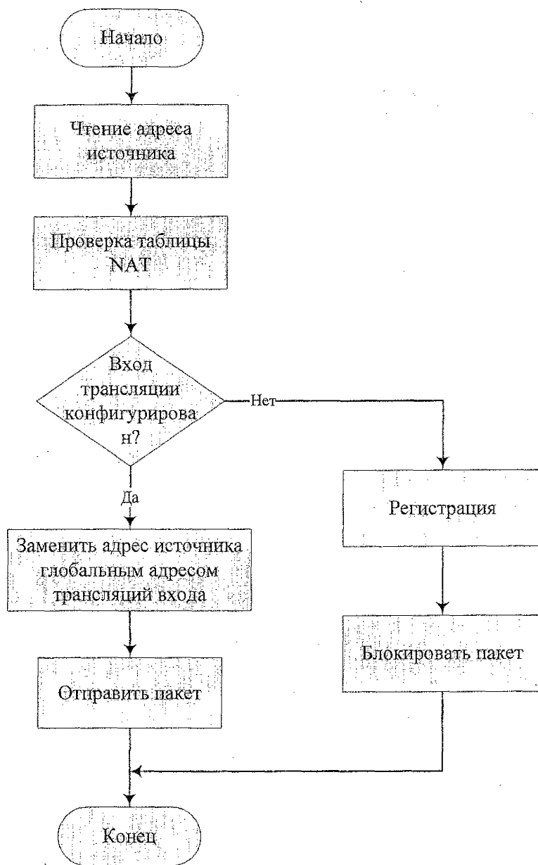
Рис. 2. Алгоритм трансляции внутреннего адреса источника статическим методом
