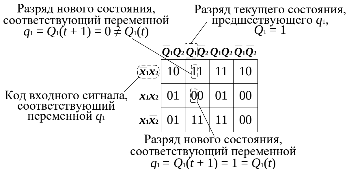
Рисунок 4.10 – Функция формирования кода перехода состояния автомата
