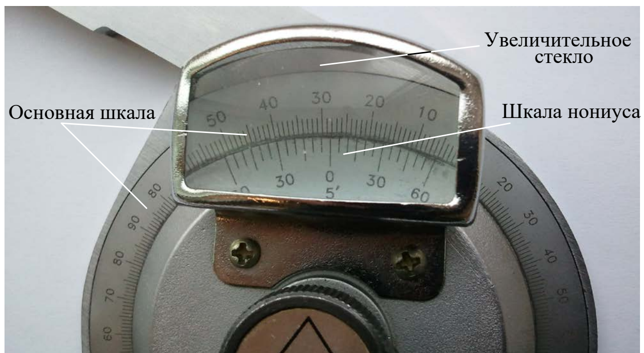
Рисунок Ж.3 – Основная и нониусная шкалы универсального угломера
