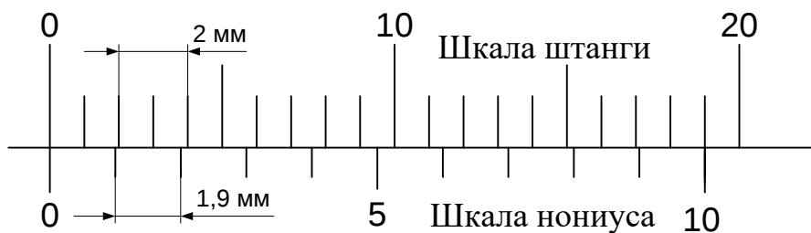
Рисунок 2.8 – Растянутый нониус с длиной шкалы 19 мм
