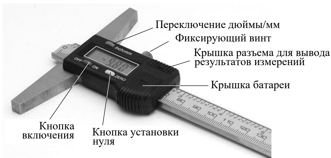
Рисунок Б.3 – Штангенглубиномер с цифровым отсчетом ШГЦ
