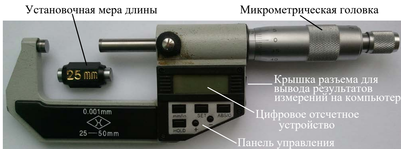
Рисунок В.2 – Внешний вид и устройство микрометра с цифровым отсчетом МКЦ
