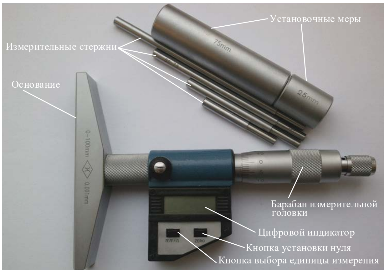
Рисунок Д.2 – Внешний вид цифрового микрометрического глубиномера ГМЦ
