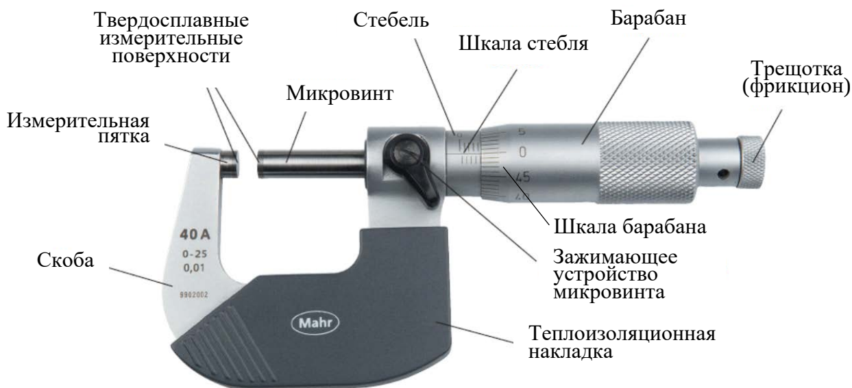
Рисунок В.1 – Внешний вид и устройство микрометра МК
