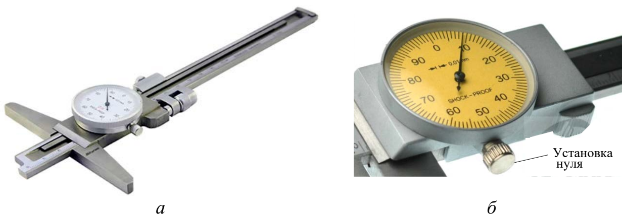
а – внешний вид; б – круговое отсчетное устройство
