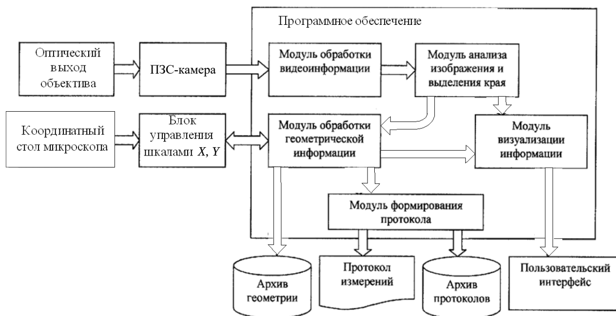
Рисунок 4.10 – Функциональная схема системы захвата изображения и автоматизированной обработки результатов измерений
