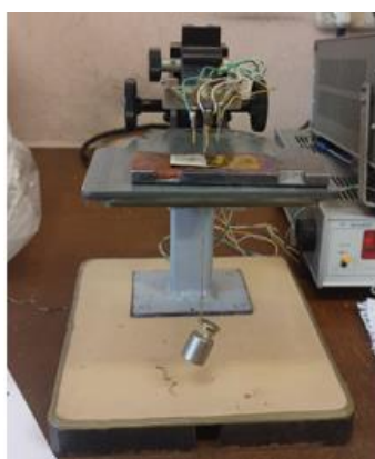
Рисунок 6.4 – Лабораторный макет, реализующий трехзондовый метод вольтамперометрии
