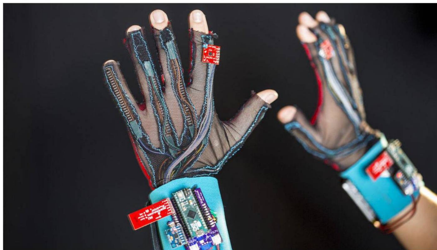
Рисунок 5 – Прототип перчаток SignAloud для перевода с языка жестов
