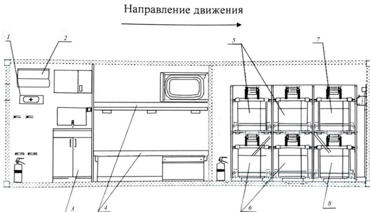
Рис. 38. Вид на левую внутреннюю стенку станции Р-414МБРП-О: 1 – аптечка; 2 – вентилятор с заслонкой; 3 – мойка; 4 – диван и откидная кровать; 5–8 – кабели на катушках
