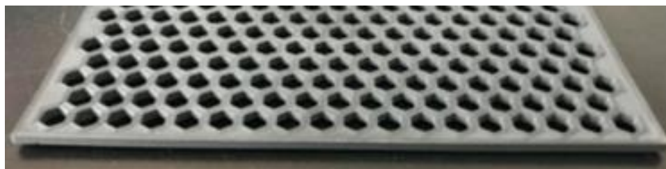
Рисунок 1.10 – Внешний вид фрагмента перфорированного электромагнитного экрана, полученного в соответствии с технологией, приведенной в [57]
