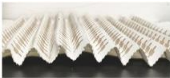
Рисунок 1.54 – Внешний вид сбоку образца электромагнитных экранов [116]
