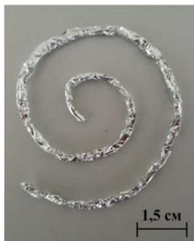
Рисунок 3.2 – Внешний вид объемного спиралевидного элемента, сформированного из фрагмента алюминиевой фольги
