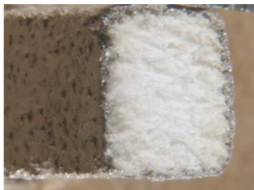
Рисунок 1.42 – Внешний вид поперечного среза части объемного элемента для электромагнитных экранов [107]
