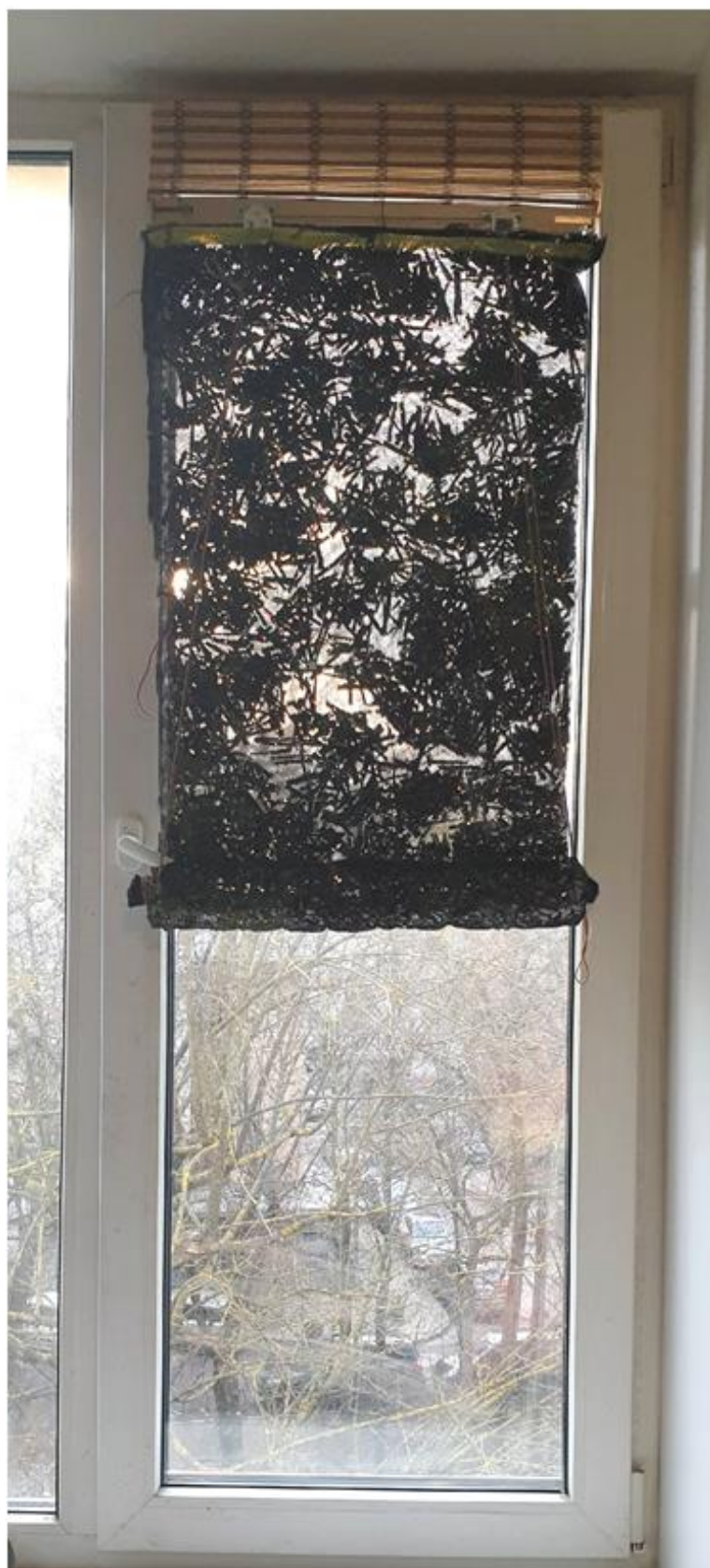
Рисунок 5.2 – Внешний вид шторы, полученной с использованием электромагнитных экранов, изготовленных в соответствии с разработанными технологиями на основе элементов из алюминийсодержащей фольгированной полимерной пленки [238]
