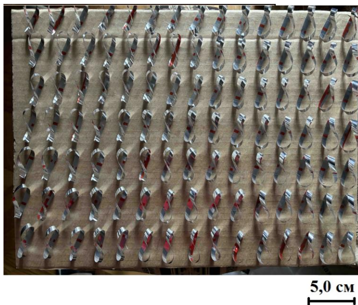
Рисунок 4.5 – Внешний вид сверху фрагмента трехслойного электромагнитного экрана, изготовленного в соответствии с представленной технологией с использованием объемных элементов в виде лент Мебиуса из алюминийсодержащей фольгированной полимерной пленки
