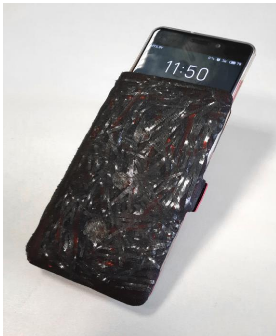
Рисунок 5.1 – Внешний вид чехла для мобильного телефона, полученного с использованием электромагнитных экранов, изготовленных в соответствии с разработанными технологиями на основе элементов из алюминийсодержащей фольгированной полимерной пленки [237]
