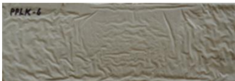
Рисунок 1.8 – Фотография фрагмента поверхности электромагнитного экрана, полученного в результате горячего прессования стальной перфорированной ленты и полипропиленовых листов
