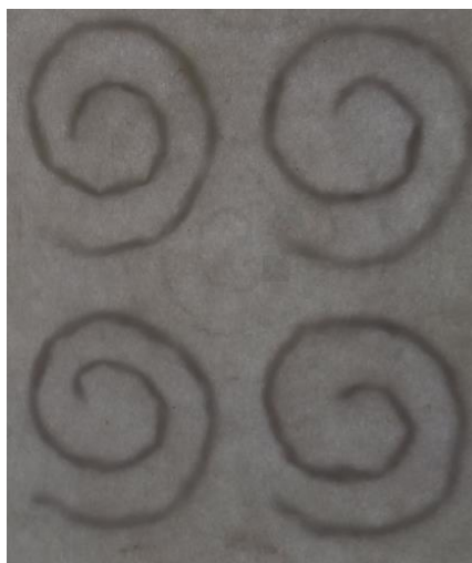
Рисунок 4.1 – Внешний вид сверху фрагмента электромагнитного экрана на основе объемных спиралевидных элементов из алюминиевой фольги
