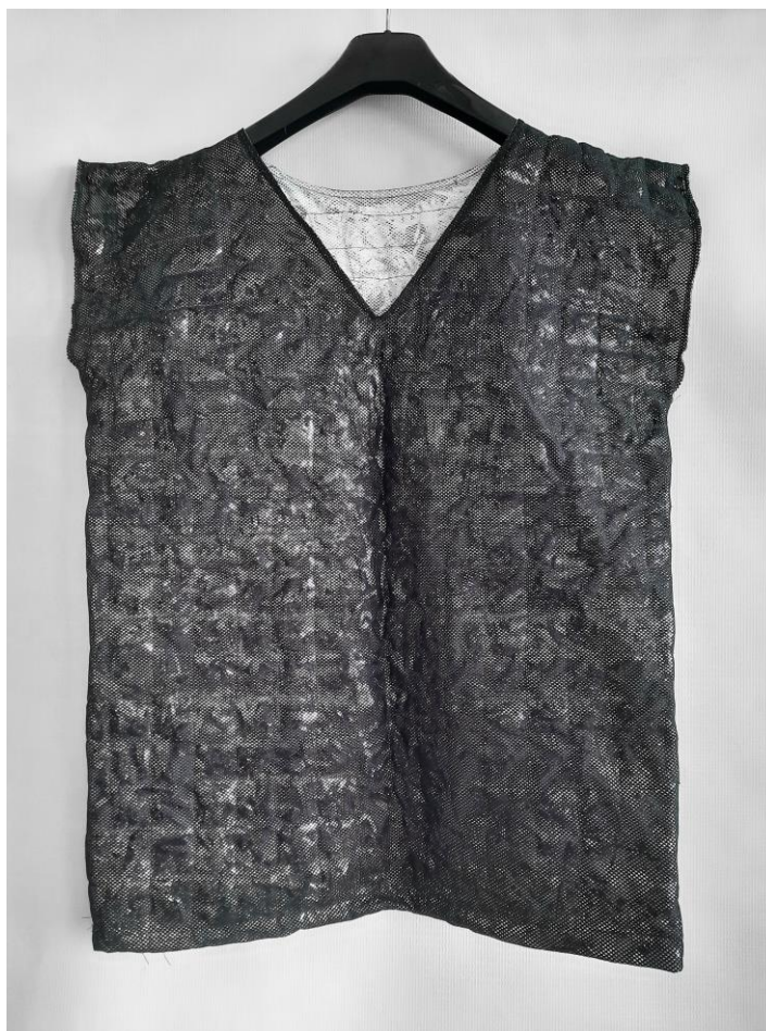
Рисунок 5.3 – Внешний вид жилетки, полученной с использованием электромагнитных экранов, изготовленных в соответствии с разработанными технологиями на основе элементов из алюминийсодержащей фольгированной полимерной пленки
