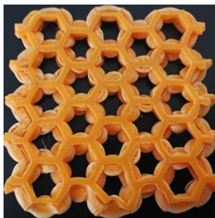
Рисунок 1.48 – Внешний вид образца одного из фрагментов подложек электромагнитных экранов [111]
