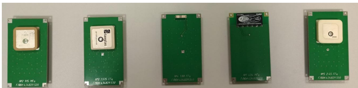
Рисунок 2.10 – Внешний вид имитаторов специальных технических средств, предназначенных для негласного получения информации, использованных в ходе проведения экспериментального обоснования
