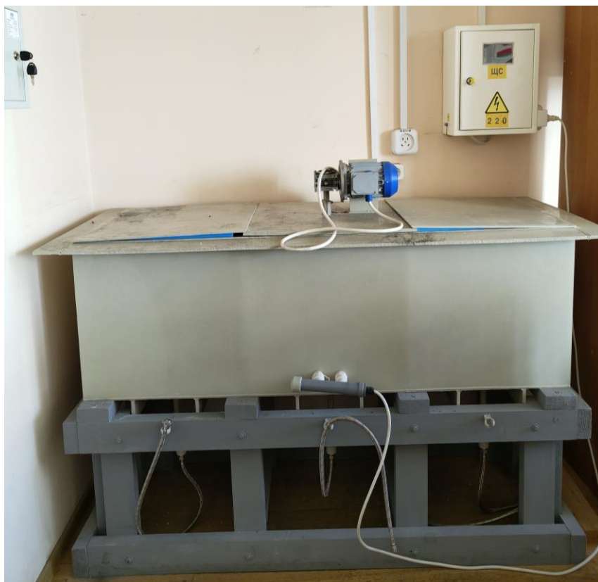
Рисунок 4.24 – Внешний вид сбоку предложенной и разработанной установки для модификации порошкообразного активированного древесного угля
