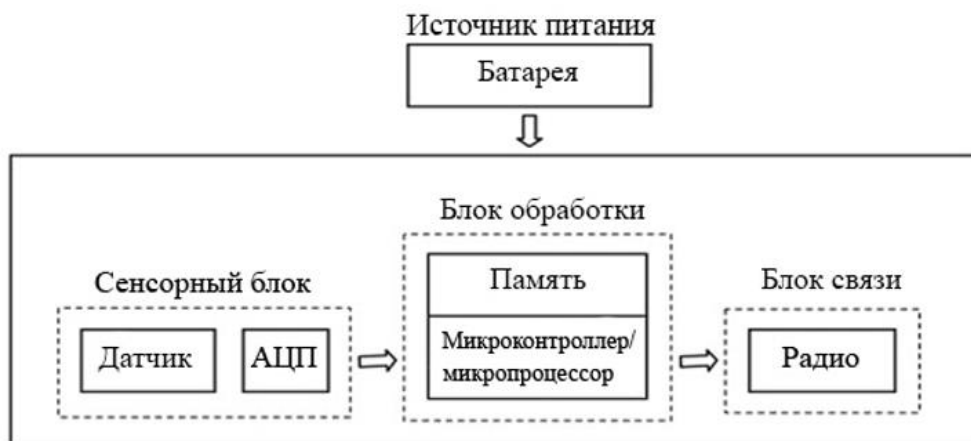
Рисунок 4 – Типовая архитектура сенсорного узла
