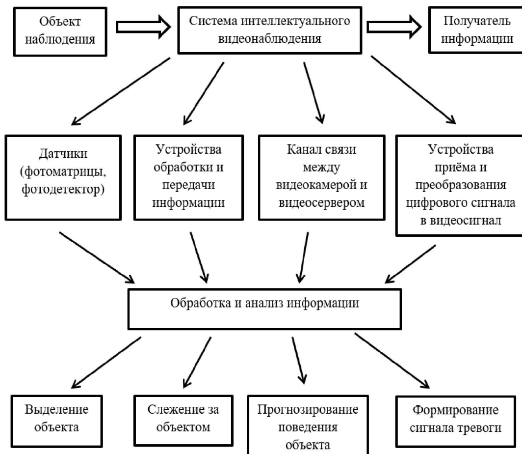
Структурная схема системы интеллектуального видеонаблюдения Structural diagram of the intelligent video surveillance system
