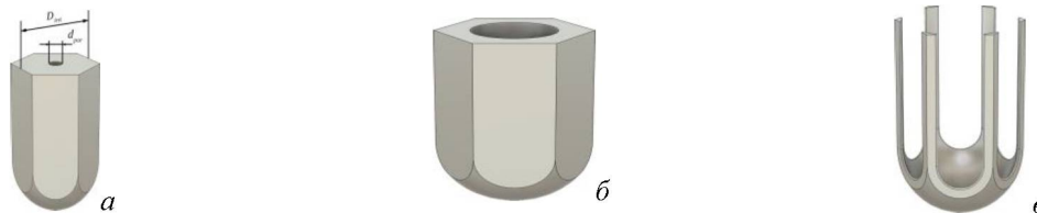
Рисунок 1 – Схематичное изображение гексагональных ячеек пористых оксидов вентильных металлов: а) ячейка с низкой пористостью (пористость 1–50 %); б) ячейка с высокой пористостью (пористость 51–90 %); ячейка со столбчатой структурой (пористость более 90 %)
