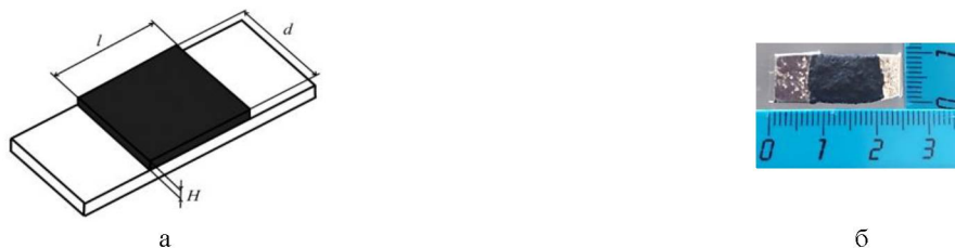
Рисунок 1 – Схематичное изображение углеродной пасты, нанесённой на стеклянную подложку, с указанием геометрических параметров слоя углеродной пасты ( l – длина, d – ширина, H – толщина слоя) (а) и фото образца (б)
